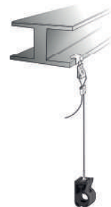
Cable hung pipe
